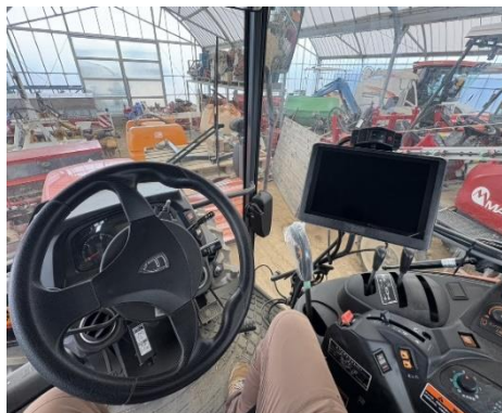
トラクターの自動操舵システム 自動レベラーシステム
