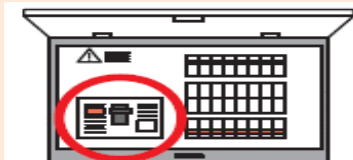
《感震ブレーカーのイメージ》 (分電盤タイプ)
