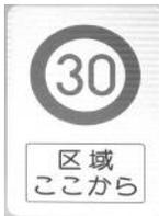
区域（ゾーン）を定めて最高速度30km毎時の速度規制を実施し、その他の安全対策（入口にゾーン30を示す舗装及び標識の設置等）を必要に応じて組み合わせながら、ゾーン内における速度抑制や抜け道として通行する行為の抑制等を図る生活道路対策です。
