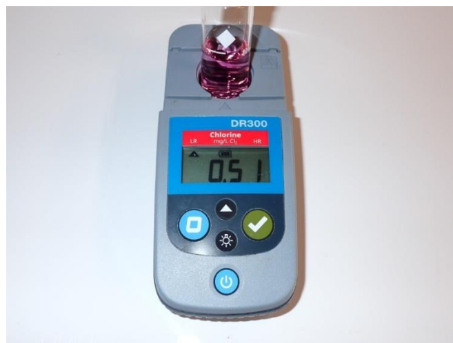
塩素濃度試験 (北部浄水場内)
