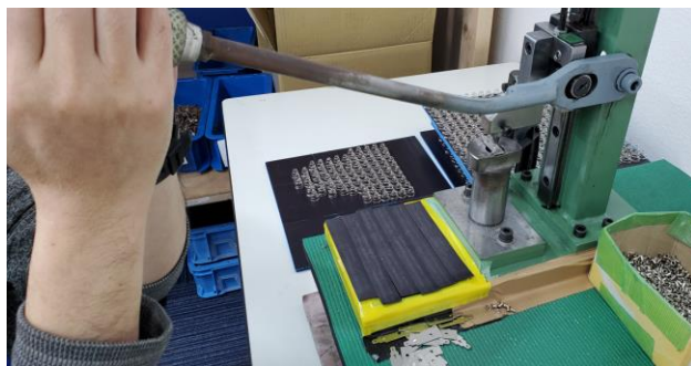
(組み立て作業)・・・必ず誰もが一度は目にしたことがある乾電池の部分を1ヶずつ組み立てていきます。
