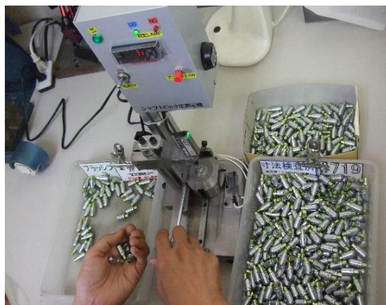
機械を使用して寸法検査
