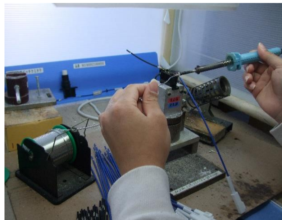
配線のハンダ付け作業
