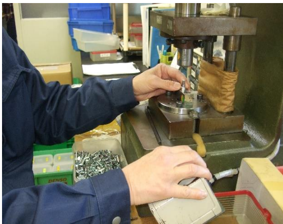
機械を使って部品のカシメ作業
