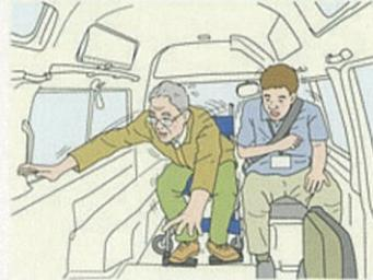
車両に乗車中のシートベルトは、一般的の座席でも車いすでも同様に必要な安全装置です。車いすにも座位保持用の安全ベルトが装着されている場合がありますが、車両のものとは目的が違いますので、必ず車両のシートベルトを装着しましょう。
