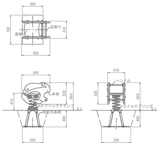
スプリング遊具 2 撤去詳細図 S=1:40
