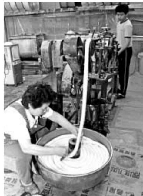
④切った生地を棒状に加工。専用の機械で数段階かけて細くしていく。
