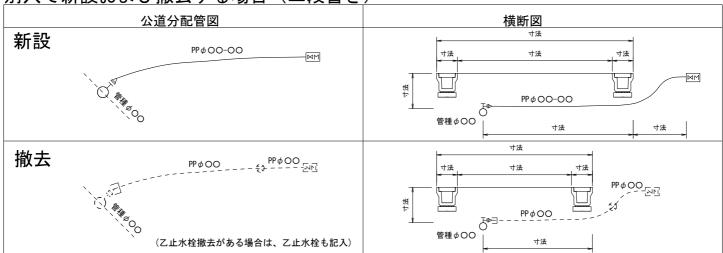
公道分配管図と横断図と給水装置設置箇所図と、取出し方向を合わせてください。
