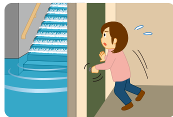
水の深さが20~30cmでも水の重さでドアは開かなくなります。
